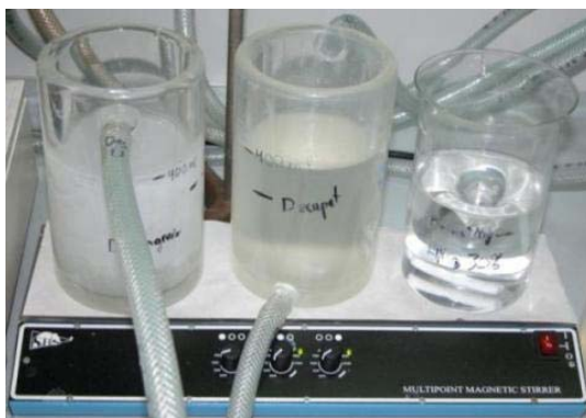
Figura 2.1. Sistema pera a pretractament de l'alumini. Esquerra: desgreix, centre: decapat i dreta: desmutting
