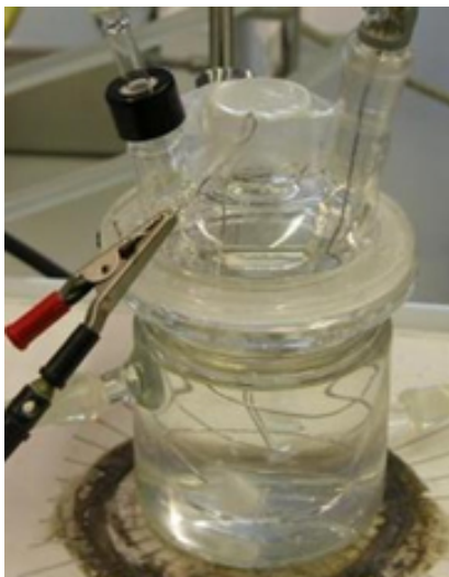
Figura 2.6. Cel·la emprada per a l'obtenció de nanofils d'or
