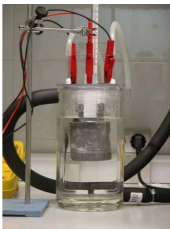
Figura 2.4. Cel·la per anoditzar en un bany d'àcid oxàlic
