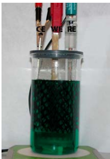
Figura 2.5. Cel·la emprada per a l'obtenció de nanofils de Ni o Co amb un bany Watts
