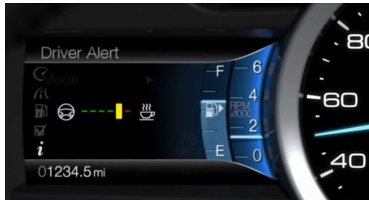
Figura 2-28. Avís proporcionat pel Driver alert de Ford. Font: [Ford 11].
