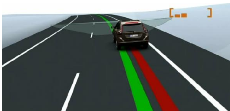
Figura 2-27. Representació del funcionament dissenyat per Volvo. En verd es mostra la trajectòria predita, mentre que en vermell la real. Font: [Volvo 08].
