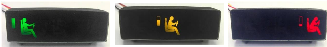
Figura 4-24. Interfície entre l'algorisme de detecció de somnolència i el conductor emprat als vehicles, mostrant els tres estats de que consta.
