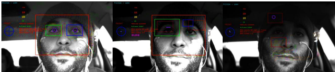
Figura 4-18. Exemples de la detecció de PERCLOS en vehicle real. A la primera imatge de l'esquerra ha estat calculat correctament, mentre que a les altres dues s'obtenen resultats incorrectes a causa d'una il·luminació irregular i amb elevat contrast. Font: UAH.
