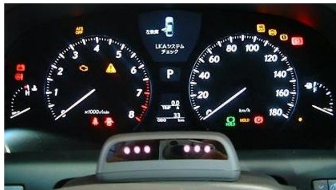
Figura 2-20. A la part central inferior de la imatge podem veure el sistema “Driving monitoring system” de Lexus, amb la càmera al centre i tres LEDs infrarojos a cada costat. Font: [Lexus ].
