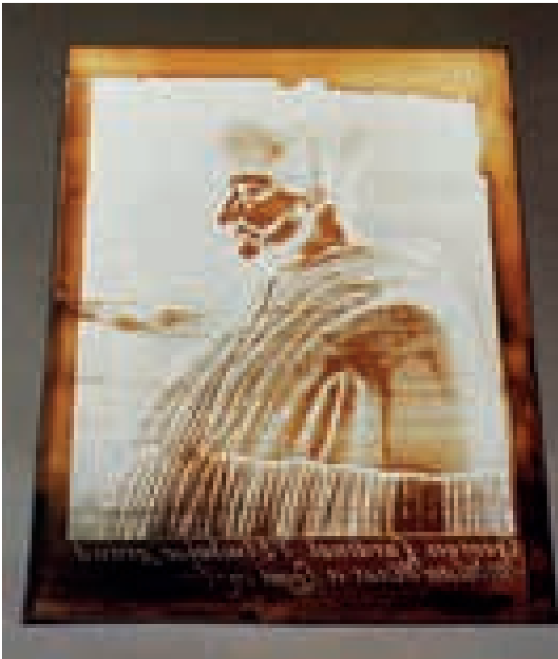
Foto 20. Después de la eliminación del betún no expuesto al sol, la imagen aparece en negativo. Pruebas realizadas por Marignier en 1989. (Marignier, 1989)
