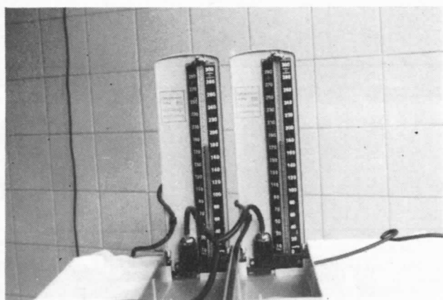
Fig. 4.— L'esfigmomanòmetre testimoni (esquerra) i el problema (dreta) marquen la mateixa xifra. Funcionament correcte.
