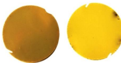
Fig. 3.3. Membrana de policarbonat de 250 mm de diàmetre (esquerra) amb un recobriments d'or en una de les cares (dreta)
