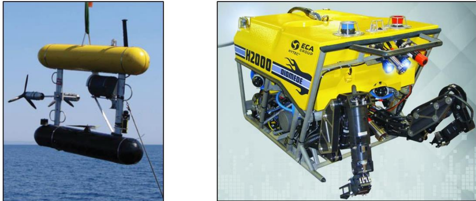
Fig. 13. i Fig. 14. Fotografies d'un AUV (esquerra) i d'un ROV (dreta). Es poden comparar ambdues morfologies, essent el primer més hidrodinàmic que no el segon. Imatges extretes de Bingham et al., 2010 i <<rovinnovations.com.>> respectivament.
