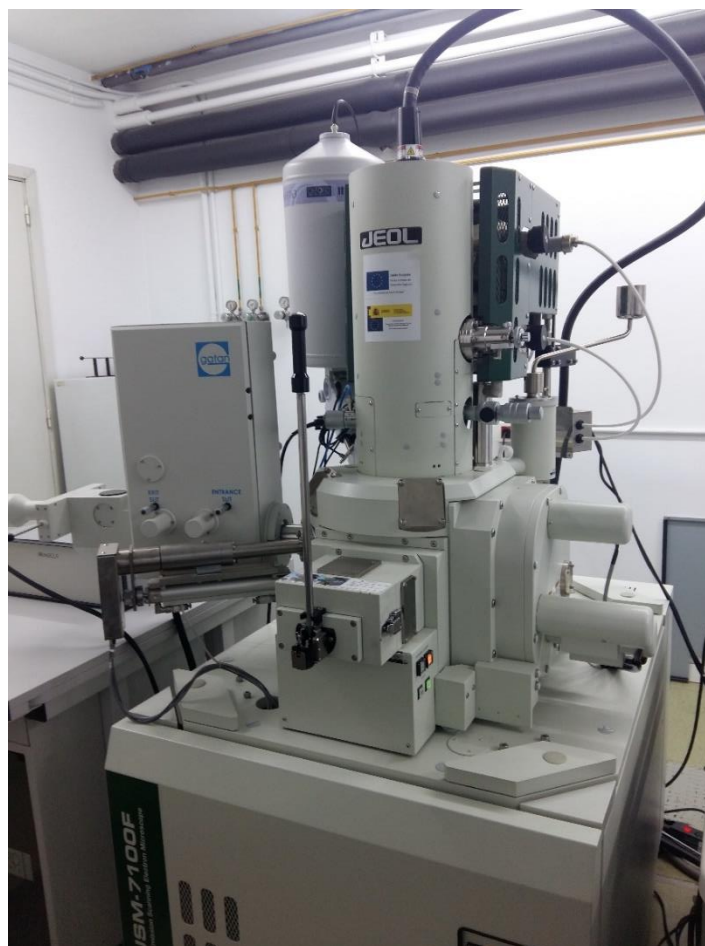
Figura 6: microscopi electrònic JEOL utilitzat per la caracterització dels vidriats
