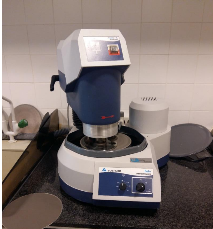
Figura 2: màquina utilitzada per la creació de seccions polides. Autor: autora del treball
