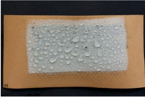
29. Despreniment de CCD en la capa aplicada en aerosol
