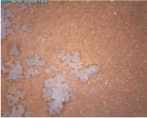
19. Detall a 50 augments dels cristalls formats al revers del suport per la penetració de la dissolució
