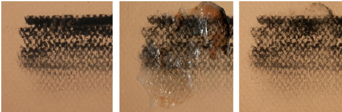
33. Comparació de les diferents fases en la mostra D1, on s'observa clarament com el CCD fos ha desplaçat partícules de carbonet, afectant a l'estrat de color
