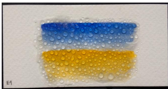
23. Aplicació d'aigua per vaporització sobre la mostra E1
