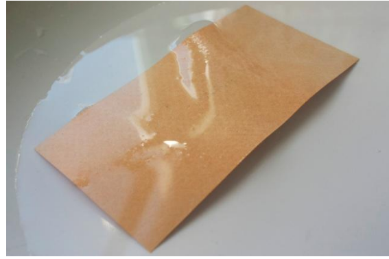
30. El CCD aplicat en aerosol no penetra en el suport, pel que no protegeix contra la penetració d'aigua per capil·laritat
