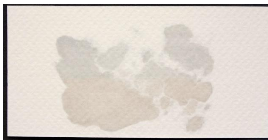
22. Taques al revers produïdes per la penetració del CCD en el suport
