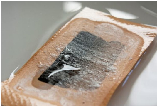
27. Detall de com el CCD repel·leix l'aigua durant la immersió
