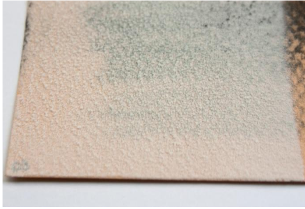
10. CCD aplicat en aerosol sobre la mostra D3, amb carbonet
