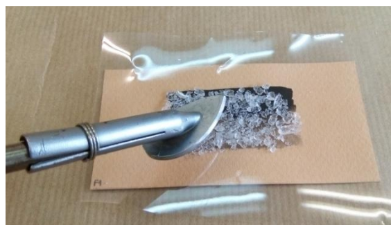
5. Aplicació d'escalfor a través de film de polièster amb espàtula calenta
