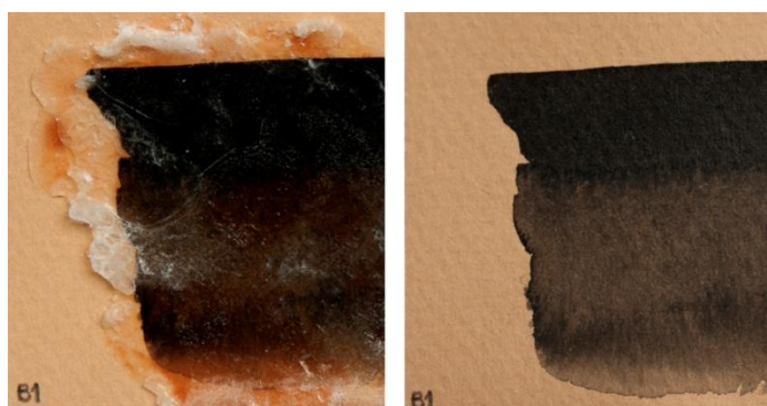
31. A l'esquerra, la mostra B1 amb el CCD aplicat fos. A la dreta, la mateixa mostra després de la sublimació del producte
