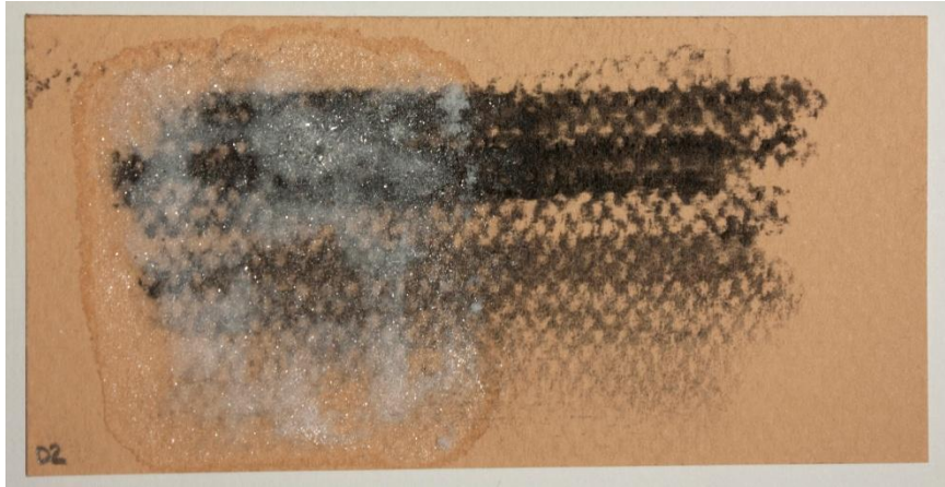
16. CCD en dissolució saturada en isooctà aplicada sobre la mostra D2, amb carbonet
