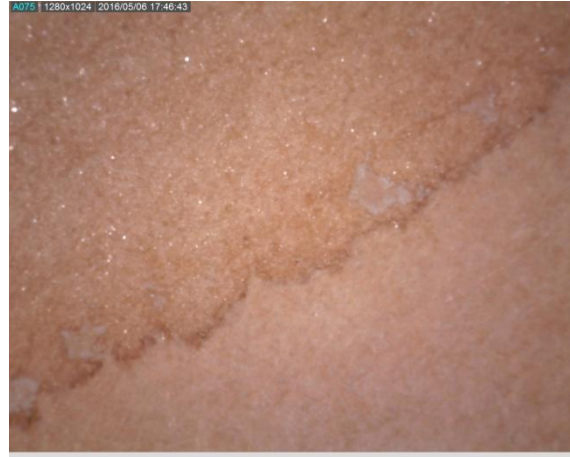
20. Detall a 50 augments de les taques per capil·laritat que la dissolució ha produït en el paper
