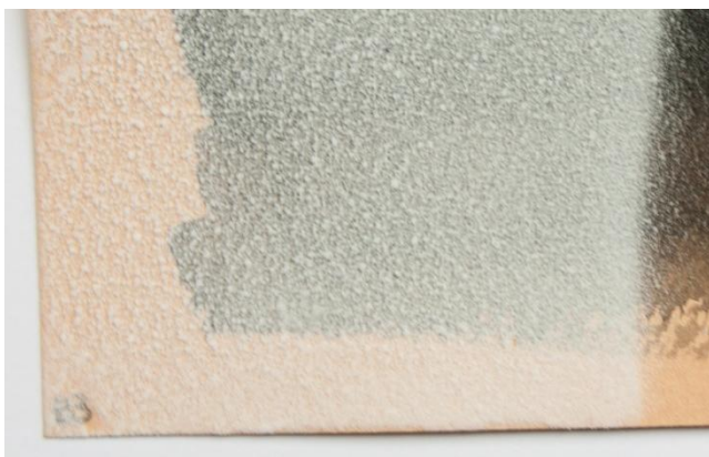
14. CCD aplicat en esprai sobre la mostra B3, amb tinta al carbó. El fet de poder escurçar la distància d'aplicació ajuda a crear estrats més fins i homogenis
