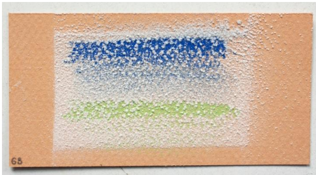
12. Sobre la mostra G3, amb pastel, el CCD en esprai forma una xarxa molt oberta i desigual, especialment sobre el pigment
