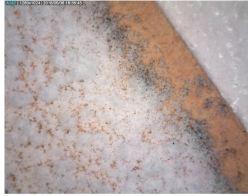
11. Fotomicrografia a 50 augments feta amb microscopi digital de superfície on es pot observar com el CCD aplicat en esprai arrossega les partícules de carbonet
