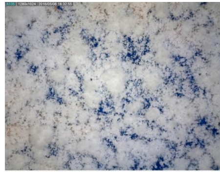
13. Fotomicrografia de 225 augments feta amb microscopi digital de superfície de la capa formada pel CCD en esprai. Es pot veure que l'estrat format no cobreix totalment la superfície i que els cristalls tenen mides desiguals
