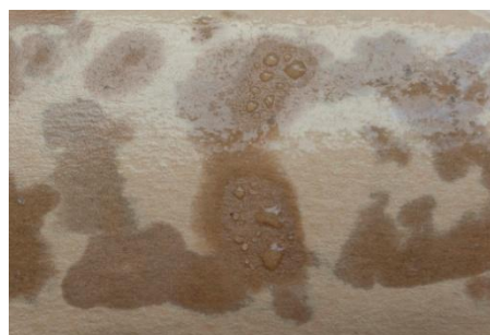
24. Detall del revers de la mostra H1. Es pot observar que el CCD ha traspasat totalment el suport en algunes àrees i ha creat una capa hidropel·lent pel revers, quedant l'aigua en superfície
