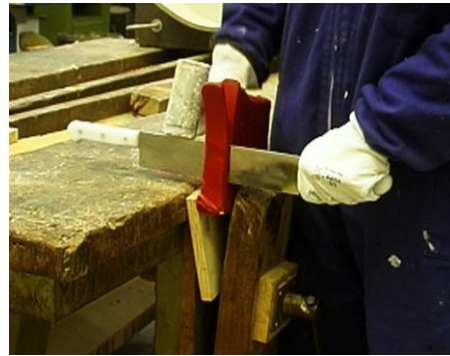
Fig. 14. Operació de tall de pastilla de cera tova amb tallanta i maceta de fibra.
