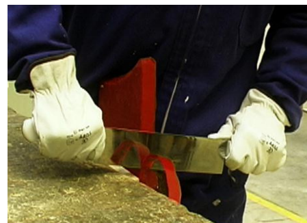
Fig. 13. Operació de tall de pastilla de cera tova amb tallanta.
