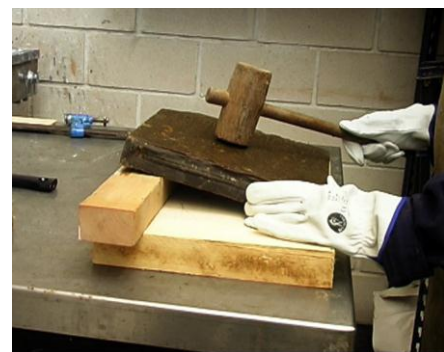
Fig. 8. Fragmentació de una pastilla de cera dura amb maceta de fusta.
