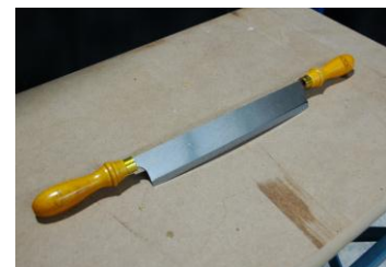
Fig. 2. Tallanta o ganivet de doble mànec
