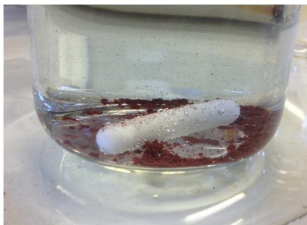
Figura 4.16. Llimadures de coure despreses del càtode durant l'assaig a 3 \text{ A/dm}^2 .
