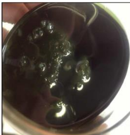
Figura 3.5. Grumolls formats a la fase orgànica durant un procés d'extracció de Cr(III) amb Primene 81R.
