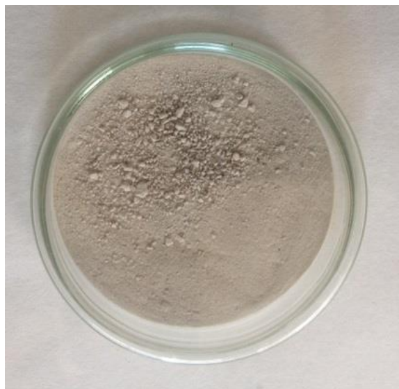
Figura 4.8. Aspecte del sòlid insoluble resultant al final de tot el procés de lixiviació àcida, rentat i assecat.
