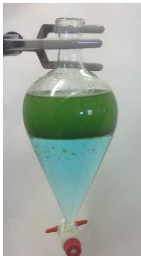
Figura 1.13. Fotografia d'un embut de decantació en una extracció líquid-líquid amb solvents orgànics a escala de laboratori.
