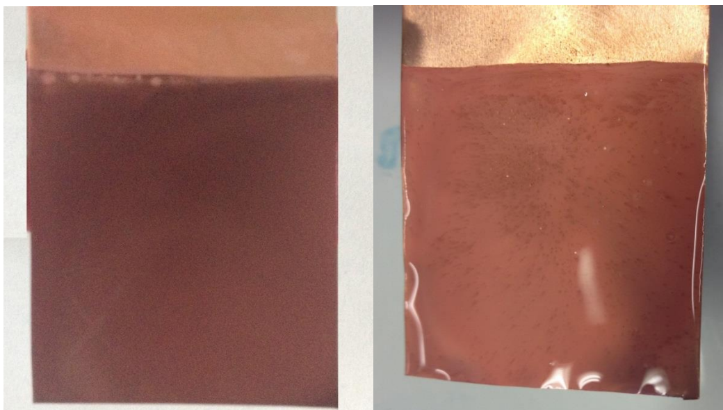
Figura 4.12. Aspecte dels càtodes obtinguts en l'electrodeposició del Cu(II) amb el lixiviats real (figura de l'esquerra) i amb la solució sintètica de composició similar (figura de la dreta).
