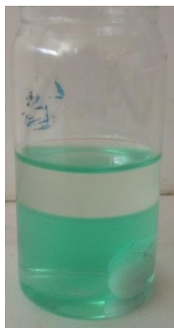
Figura 4.58. Imatge que s'obté al posar en contacte una solució aquosa de sulfat de níquel(II) amb una fase orgànica amb Primene 81R. El color original de la solució de sulfat de níquel(II) no canvia per la presència de la fase orgànica.
