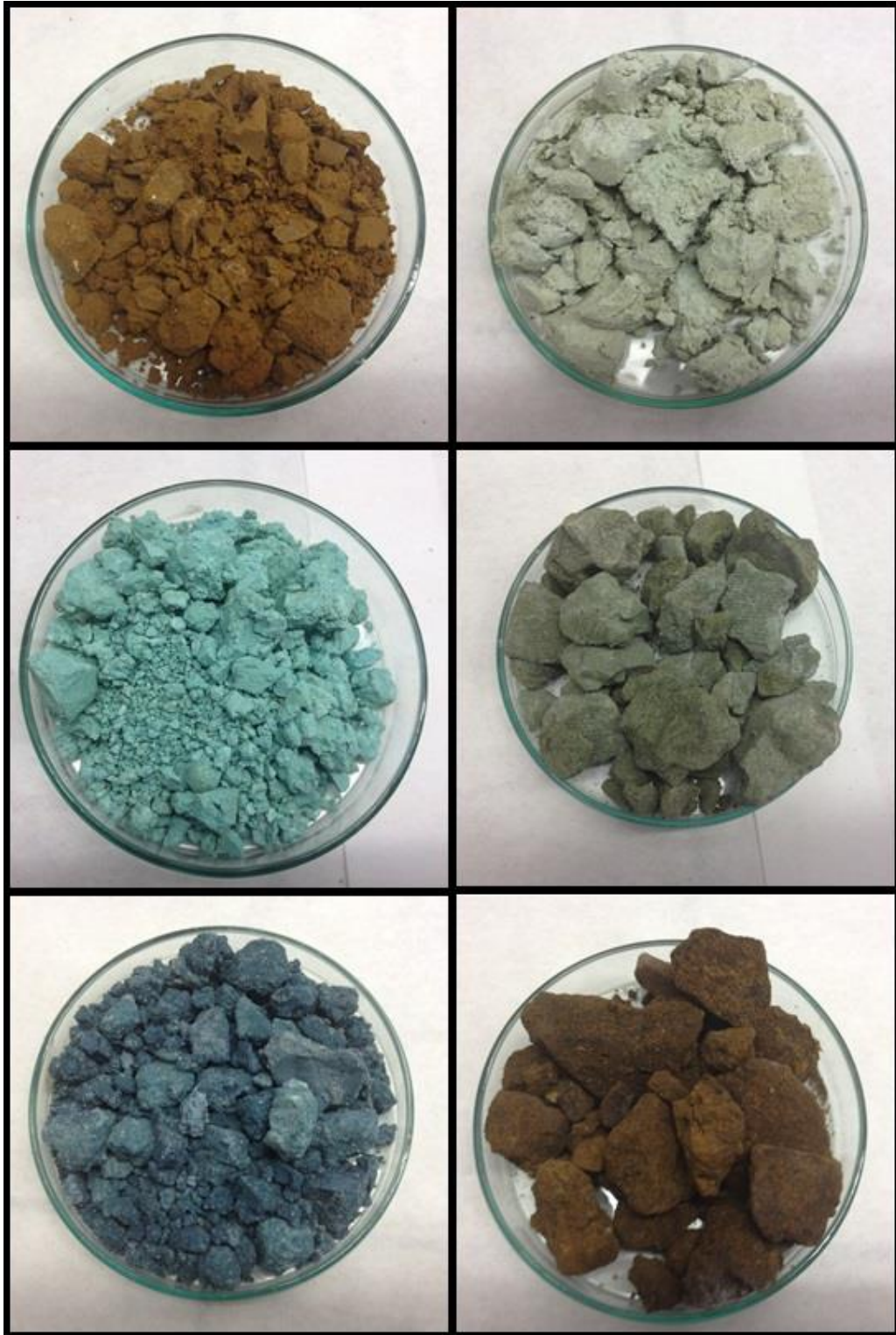
Figura 1.6. Aspecte de fangs d'hidròxids metàl·lics resultants del tractament d'aigües a les depuradores provinents de diferents empreses galvàniques.
