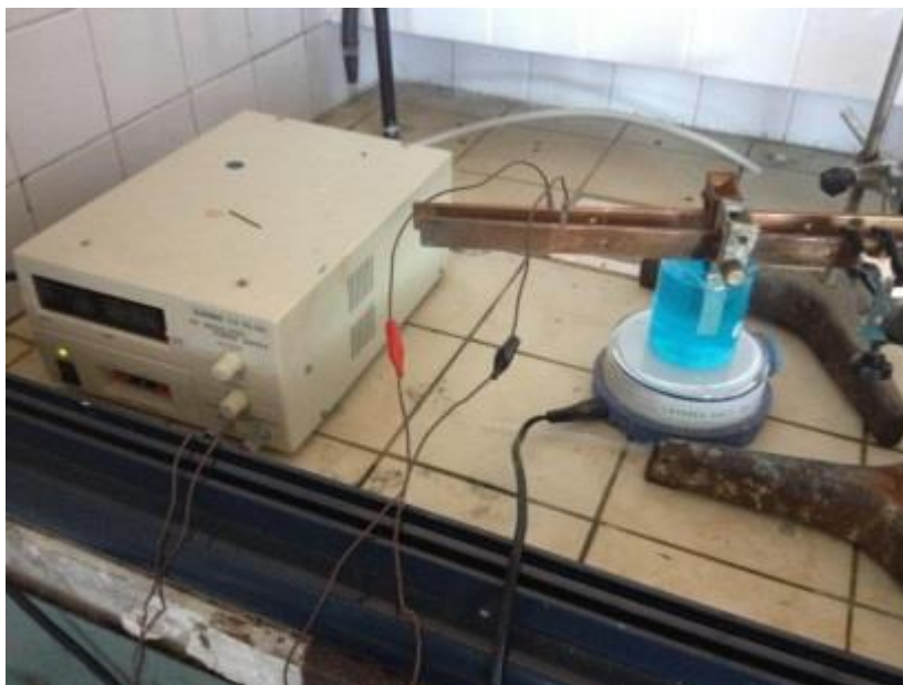
Figura 3.2. Instal·lació del sistema d’electro-deposició de Cu(II).
