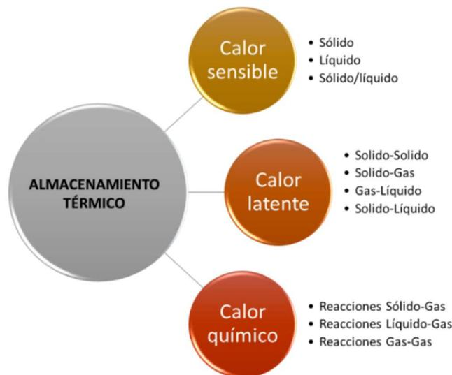
**Figura 1.** Clasificación de las formas de almacenamiento térmico. Adaptado de las Refs. [[4],6].
