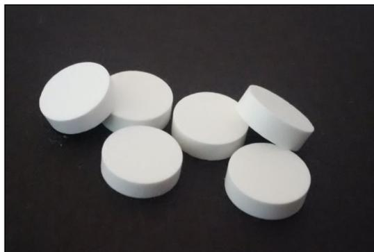
**Figura 64** Aspecto comprimidos de 53A a 15 KN.
