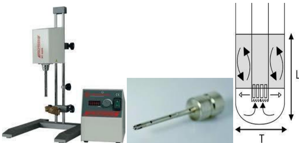
Figura 4. Polytron para homogenización de tejido tumoral a estudiar conbuffer U9 de Bio-Rad a una velocidad hasta 30.000 revoluciones por min. (Proceso que impide la desnaturalización o alteración de la proteína durante su estudio posterior).
