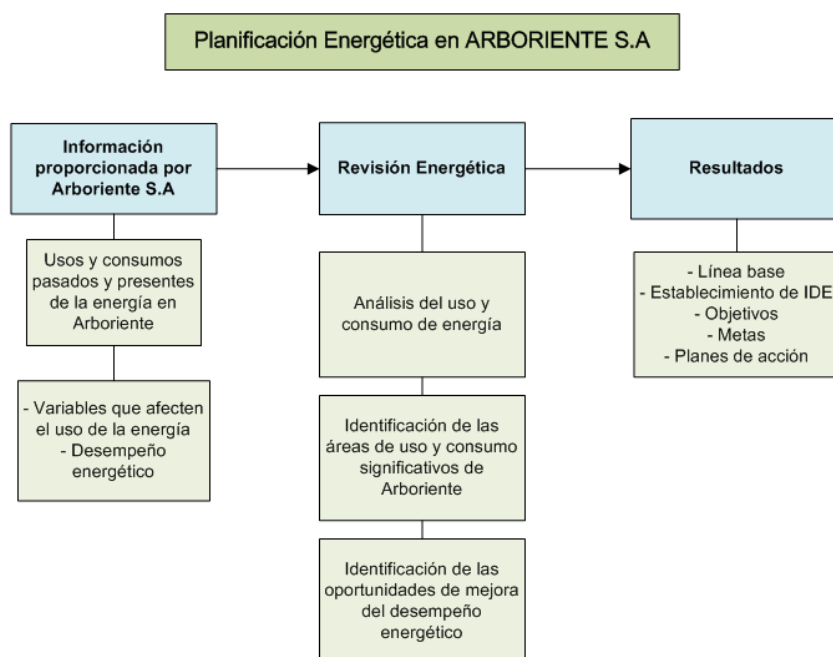
Figura 6. Diagrama del proceso de planificación energética. Fuente: ISO 50001
