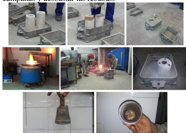
Figura 3. Proceso de obtención de una campana.
