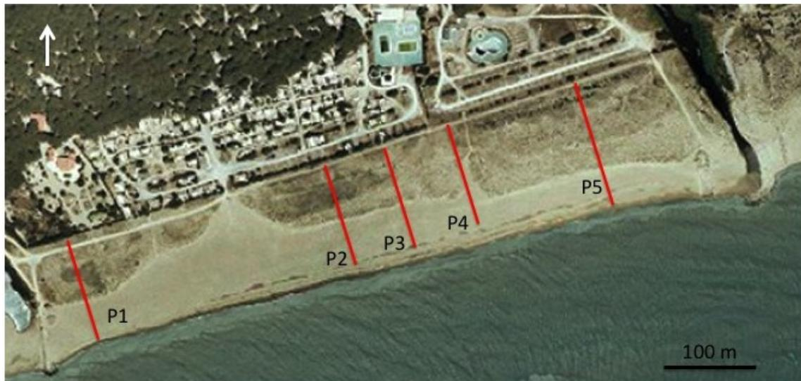
FIGURA 1. Vista aérea de la playa del Remolar en el año 2003. Se observa la regresión del sistema dunar, debida principalmente al pisoteo de las dunas. Se han localizado los perfiles topográficos y de GPR (P1-P5). Los estudios de vegetación se realizaron en los mismos perfiles.
