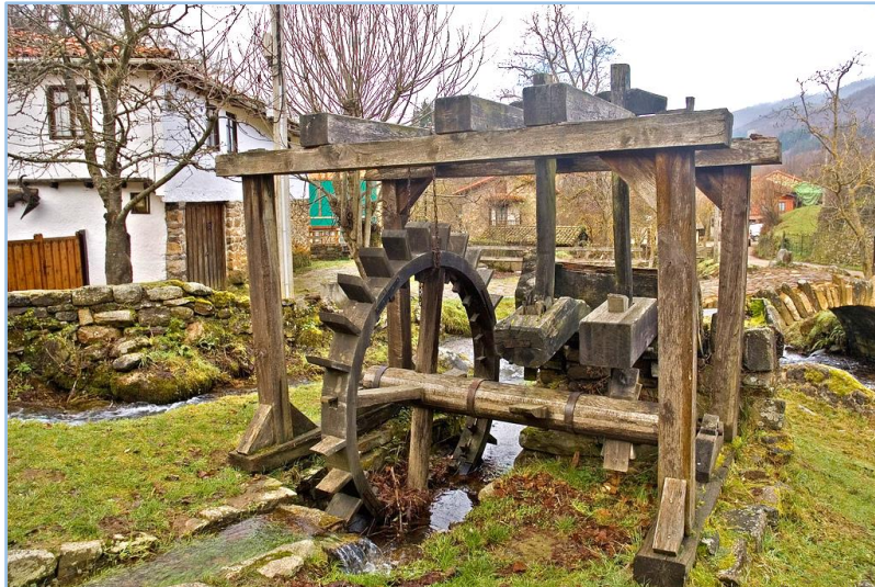
Figura 24 - Mecanisme d'un molí draper a Aniezo, Cantabria. La força de l'aigua mou la roda vertical, la qual, a partir del seu eix, posa en moviment les maces que bategen les peces de teixit col·locades verticalment sobre una estructura de fusta.
