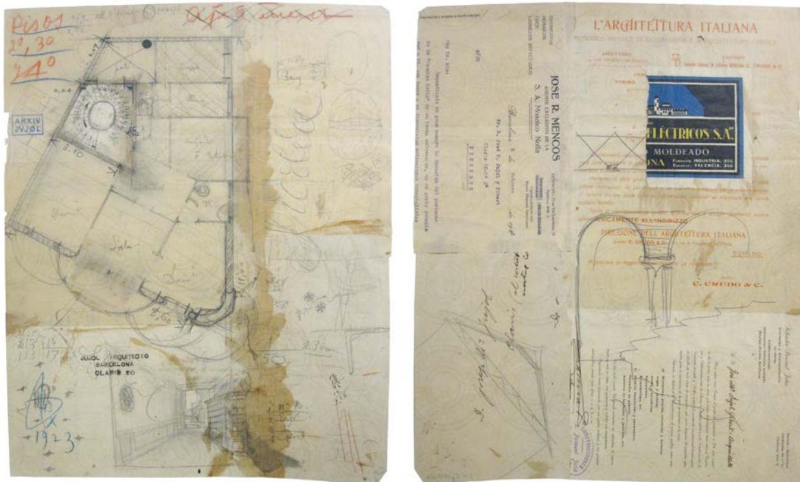
Fig. 23 i Fig. 24. Anvers i revers d'un plànol de planta de Josep Maria Jujol on s'aprecia l'encaix de diferents papers opacs provinents de peces de tot tipus reaprofitades (casa Planells, Josep Maria Jujol, 1922-1924). Font: AHCOAC C1197/23.11.3.
