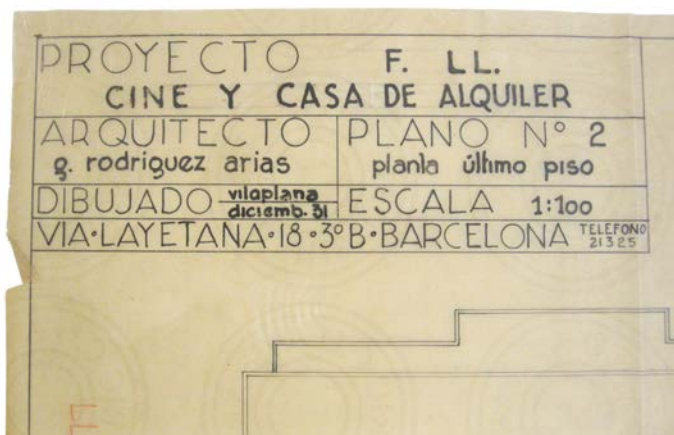
Fig. 247. Caràtula estandaritzada (casa Fèlix Llobet/casa cine Florida, Germà Rodríguez Arias, 1931). Font: AHCOAC C812/22.
