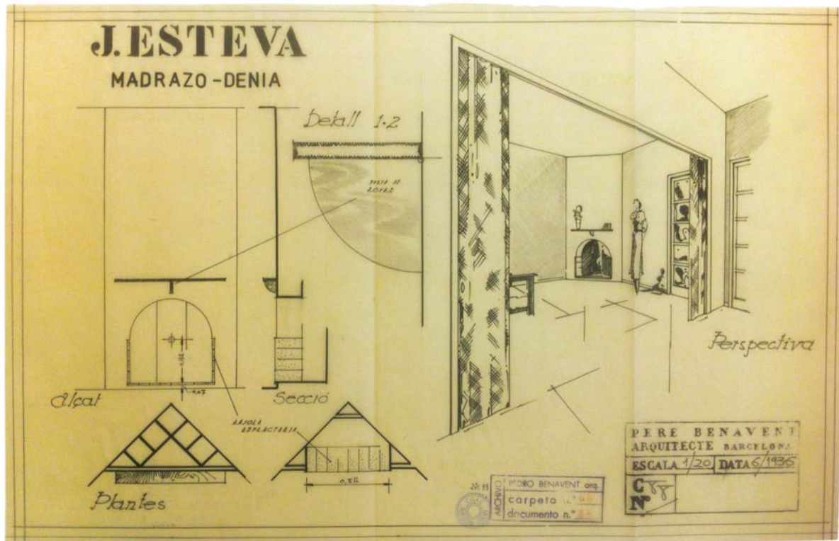
Fig. 69. Plànol de la llar de foc que inclou alçat, plantes, secció i perspectiva interior (casa Jacint Esteva, Pere Benavent, 1936). Font: AHCOAC 271.33.
