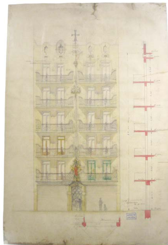
Fig. 72. Plànol de façana i secció de façana (casa Antònia Lull, Josep M a Jujol, 1922). Font: AHCOAC H104B/1/22.2.
