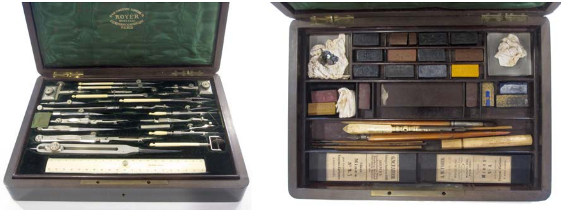
Fig. 12 i Fig. 13. Joc de compassos Royer del fons Bassegoda de l'AHCOAC. La primera safata (imatge de l'esquerra) conté els compassos i instruments de dibuix. La segona safata (dreta) conté pastilles de tinta, pinzells, plomins i mines de llapis. Font: AHCOAC.
