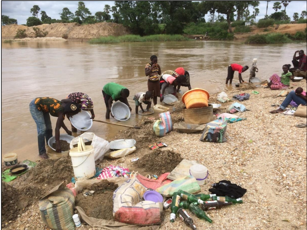
Figura 2.1.27. Vilatans en plena operació de separació de fins i rentat amb àbacs. Betare Oya. Camerun. Font: Serra, 2016
