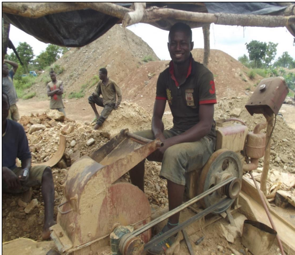
Figura 2.1.15. Miner treballant amb una trituradora. Dakurpe. Ghana. Font: Serra, 2012.
