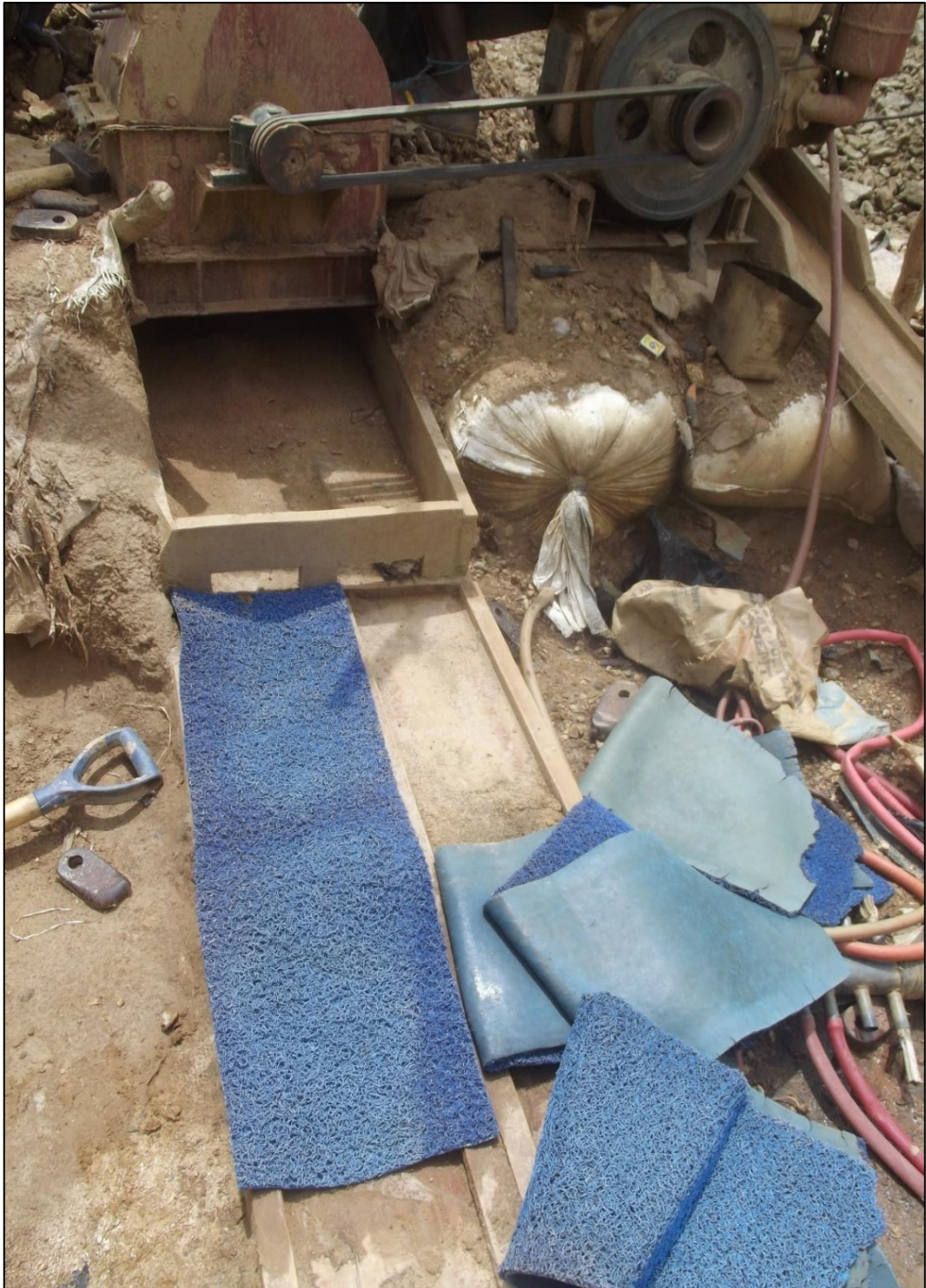
Figura 2.1.16. Detall de les moquetes utilitzades per retenir els grans de material pesant. Dakurpe. Ghana. Font: Serra, 2012.
