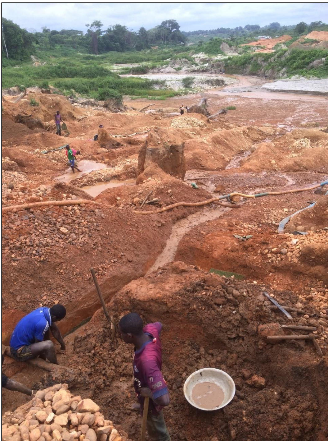
Figura 2.1.28. Miners preparant canals de desaigua del tipus manual. També amb mànegues que propulsen l'aigua des del riu fins la zona de rentat hidràulic. Betare Oya. Camerun. Font: Serra, 2016.
