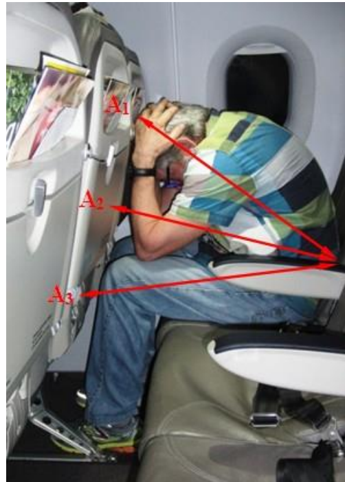
Fig. 3.9. Con la distancia “A” = 66,0 cm, de la Normativa AN64, una persona de talla media solo puede adoptar la posición de auto-protección (“Brace position”) si tiene mucha flexibilidad de tronco.
