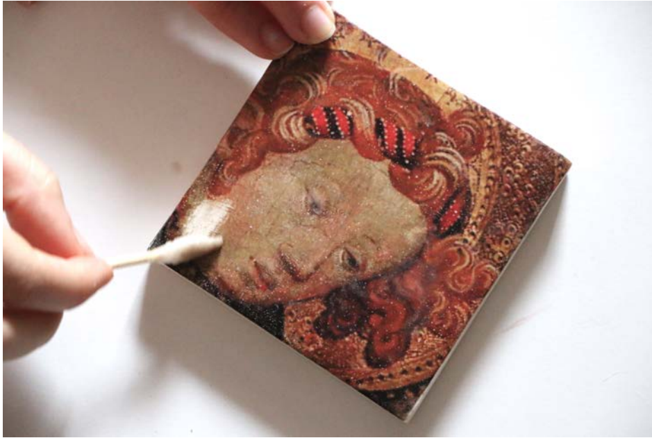
Imatge 47. Imatge de la prova de solubilitat amb aigua desionitzada sobre la Proveta 1). Irene Bujalance Cuesta©
