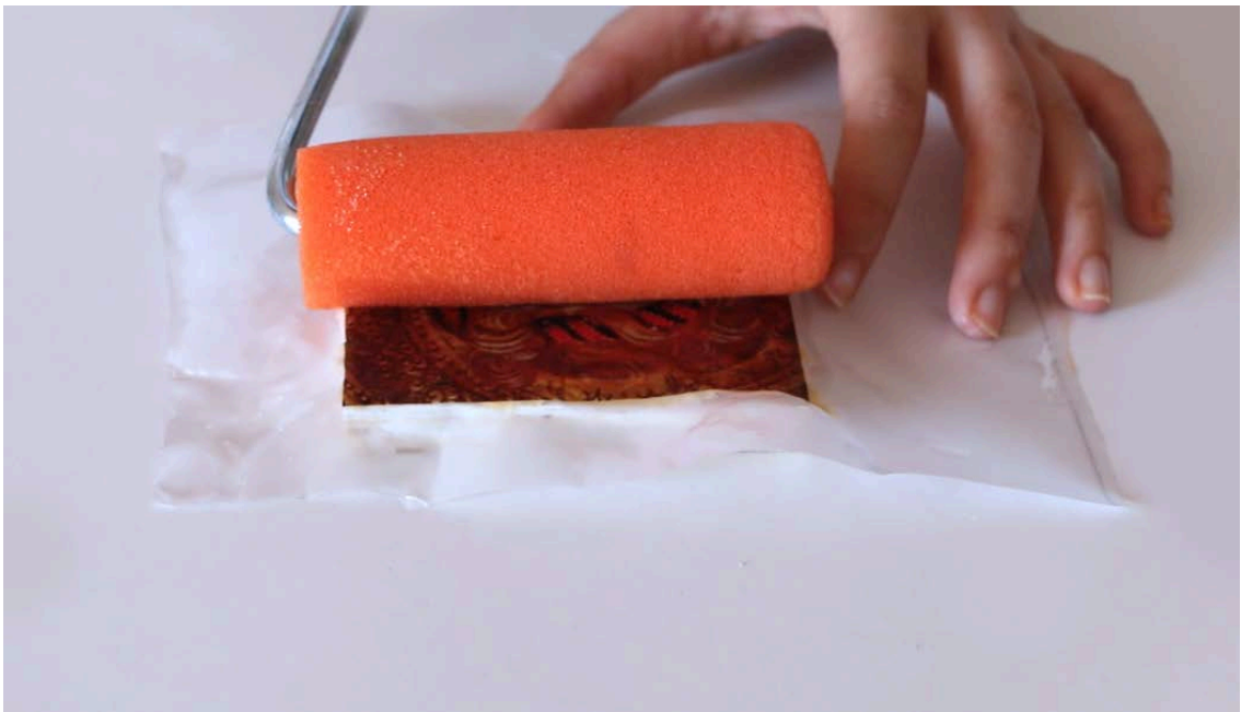
Imatge 37. Aplicació d'humitat i de pressió sobre la proveta mitjançant un corró d'escuma. Irene Bujalance Cuesta©
