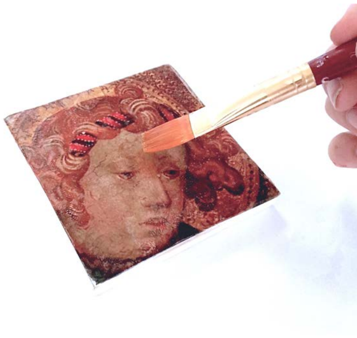
Imatge 38. Procés d'aplicació amb paletina sobre una de les provetes del Regalrez™ 1094 al 30% en White Spirit. Irene Bujalance Cuesta©
