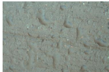
Fig.21 i 22. Imatges realitzades sota OM en les que s'observa la superfície de vidre abans i un cop eliminat el [C_5O_2MIM][Cl] .
