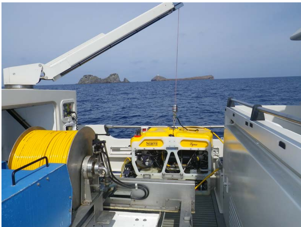
Figura 3. ROV Seave Lynx 1500 en las aguas circundantes a la Reserva Marina de las Islas Columbretes.
