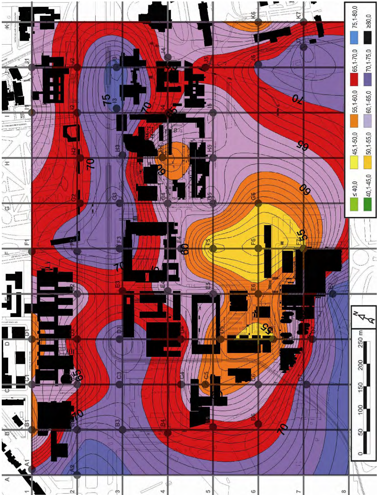
Figura 33. Nivell de soroll L_{10} , en dB(A), entre les 8 i les 11h ( L_{10} – Torn 1).
