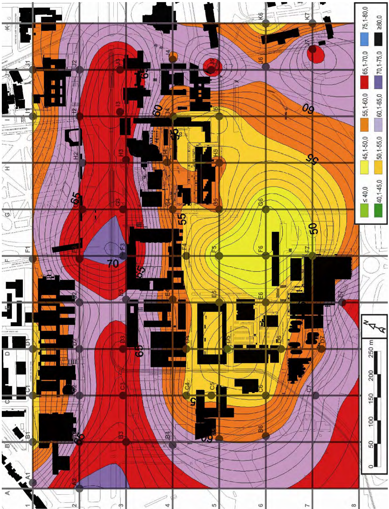
Figura 38. Nivell de soroll L_{50} , en dB(A), entre les 11 i les 14h ( L_{50} – Torn 2).
