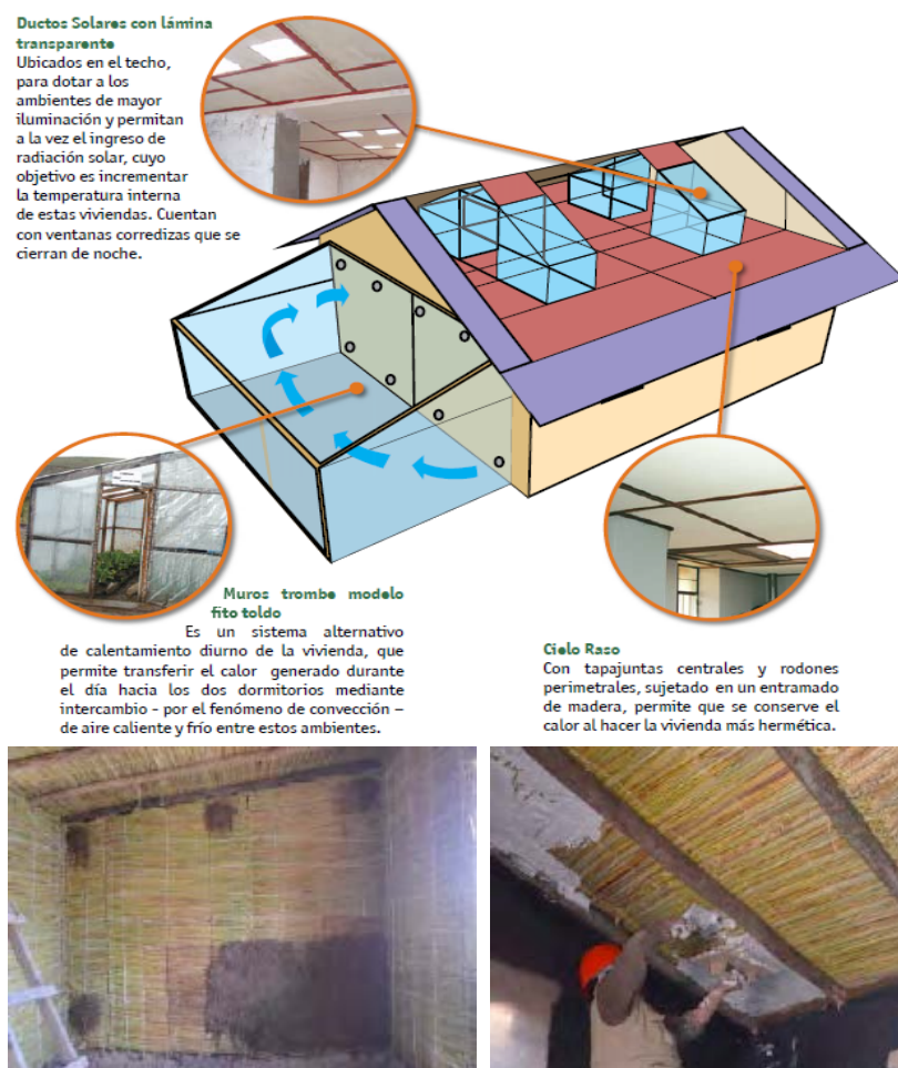
Figura 8. Vista externa e interna de vivienda con protección térmica. [14].
