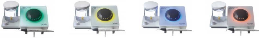
Figura IV-6: Codi de colors de l'aparell d'ultrasons utilitzat en l'estudi ordenats d'esquerra a dreta de menys a més potència
