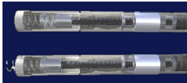
Figura II-7: Elèctrodes de fixació activa
