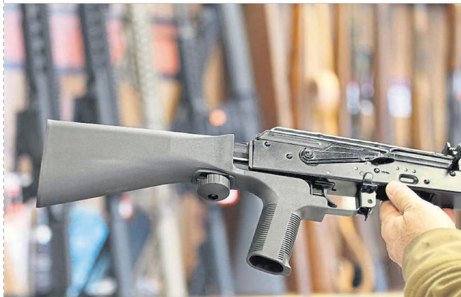
Imagen de la culata de recambio con el dispositivo especial que convierte un fusil semiautomático en una metralleta
