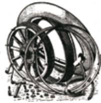
Complication : Un pneu « Straight Side » et ses accessoires de montage sur jante amovible démontable.
