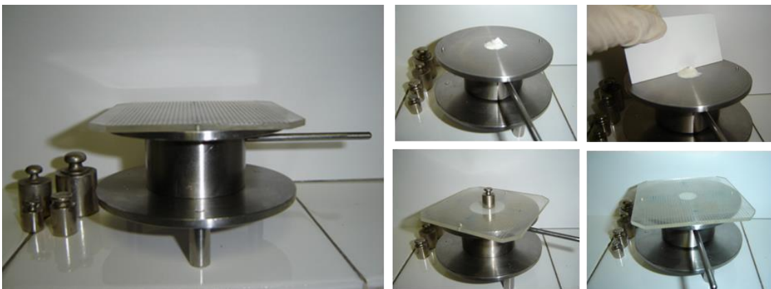
Figura 73. Extensómetro y modo operatorio.
