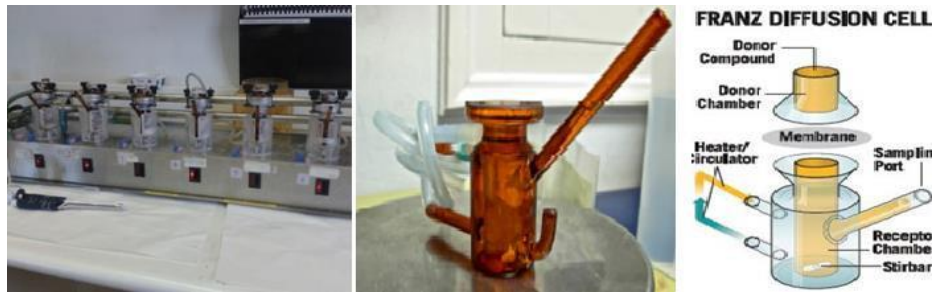
Figura 76. Imagen de la celda de Franz (izquierda y en medio) y esquema de los componentes de una celda de Franz (derecha).
