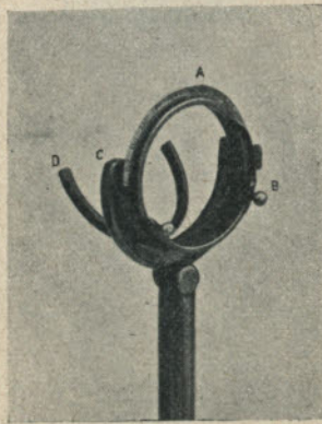
Figura 21.—Anillo E del banco de óptica. A , anillo graduado rotatorio para sostener los cristales cilíndricos. C , ranura para cristales esféricos. D , ranura que permite la descentración horizontal.
