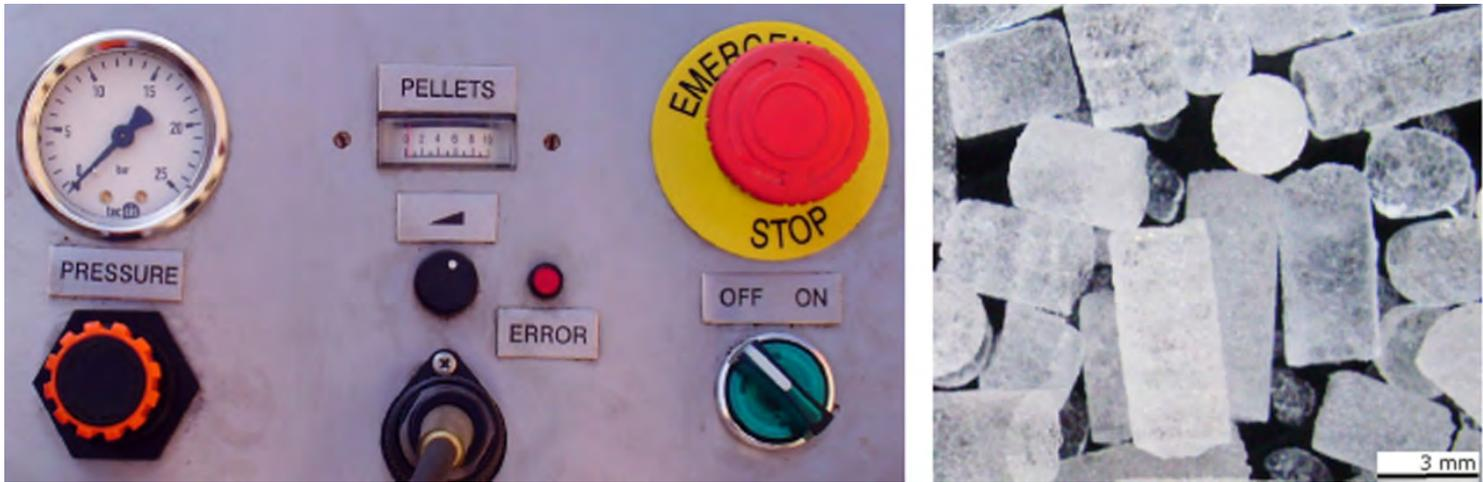
Figura 1. Detalle del panel de control de un equipo de limpieza criogénica (izquierda), y fotomacrografía de pellets de hielo seco (derecha).
