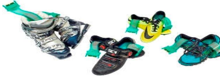
**Figura 3. Palmillas del sistema F-Scan dentro del calzado.** Tekscan [En línea]. South Boston, United States [Consulta 24 de abril de 2019]. Pressure Mapping, Force Measurement & Tactile Sensors. Disponible en: <https://www.tekscan.com/products-solutions/systems/f-scan-system>
