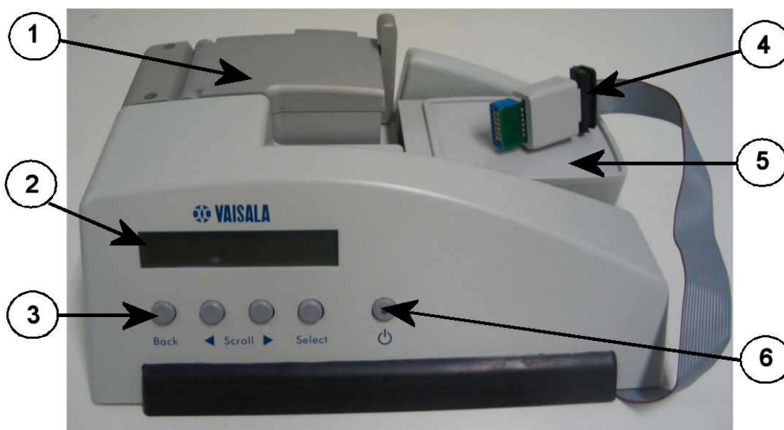
Figura 2.7. Ground Check Vaisala GC25. 1: cambra 2: display 3: Botons 4: Cable de comunicació 5: Safata de la radiosonda 6: Interruptor d'energia. (Font: Vaisala)
