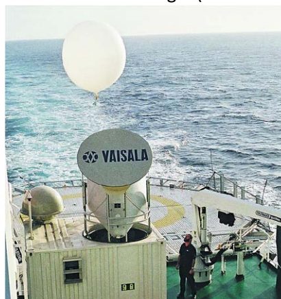
Figura 1.9. Mapa d'ASAP (Automated Shipboard Aerological Programme) de tots els radiosondatges realitzat al llarg d'un mes de l'any 2008. El contenidor, de 3 m de diàmetre, inclou tots els instruments necessaris per a la realització d'un radiosondatge. (Font: ASAP)
