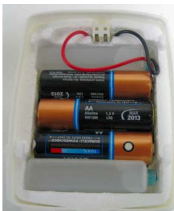
Figura 2.3. Bateria seca RSB511 i bateria activada amb aigua RSB912P (Font: Vaisala).
