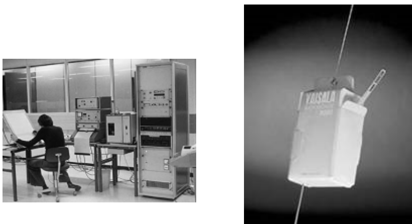
Figura 1.6. Esquerra: Sistema de sondatge manual. No va ser fins el 1976 que la companyia Vaisala Oy (Finlàndia) va introduir el primer computador que controlava els sondatges. Dreta: quarta generació de radiosondes (anys 80).
