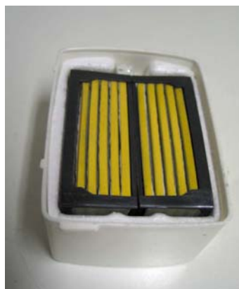
Figura 2.3. Bateria seca RSB511 i bateria activada amb aigua RSB912P (Font: Vaisala).
