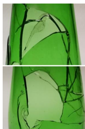
Figura 16 – Detall de les pèrdues del recipient 3
