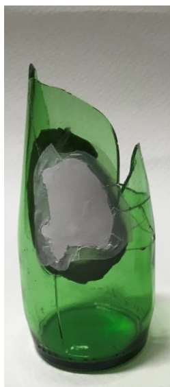
Figura 46 – Motlle un cop aplicada l'escaiola. Font: © C. Zabala (2019) 46_M3_DTI_motlle_escaiola.jpg
