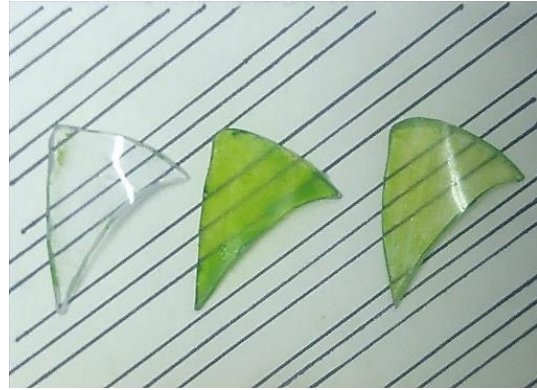
Figura 64 –Peces de plàstic acolorides amb pintura acrílica (per ordre: Polièstirè, PET, PETG) . S'observa com la pintura no s'ha agafat en la primera superfície. Font: © C. Zabala (2019) 64_M4_DT_peces_plastic_acolorides.jpg
