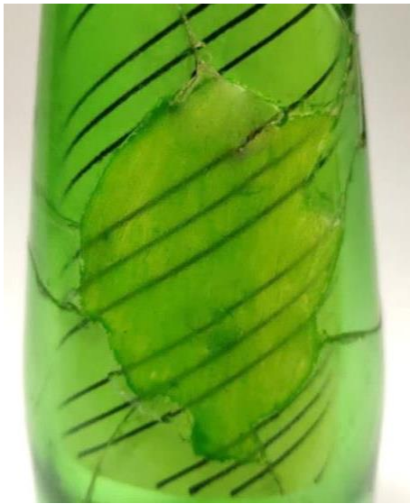
Figura 42 – Detall reintegració amb resina epoxídica amb pintura acrílica. Font: © C. Zabala (2019) 42_M2_FT_detall_epoxi_pintura.jpg
