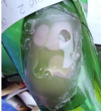
Figura 80 – Bombolles d'aire que es generen dins el motlle de cera. Font: © C. Zabala (2019) 80_M2_bombolles_aire.jpg
