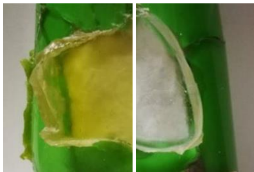
Figura 86 – Diferència entre la resina de polièster (esquerra) i la resina epoxídica (dreta) en un gruix considerable. Font: © C. Zabala (2019) 86_composicio_diferencia_groc2.jpg
