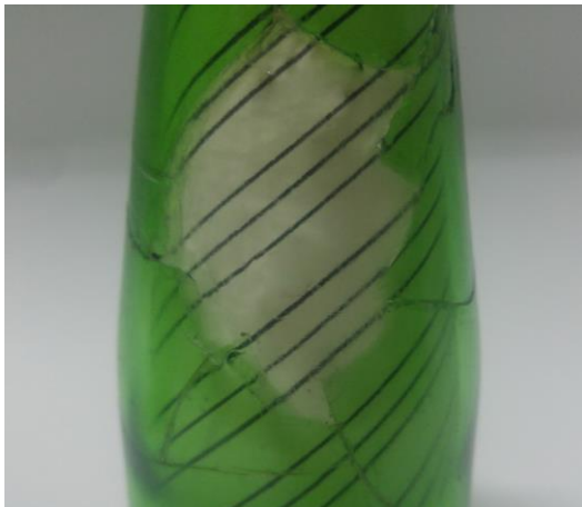
Figura 40 – Detall reintegració amb resina epoxídica. Font: © C. Zabala (2019) 40_M2_DT_detall_epoxi.jpg
