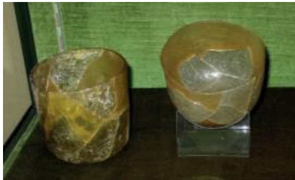
Figura 87 – Canvi d'aparença de la resina de polièster amb el pas del temps.
