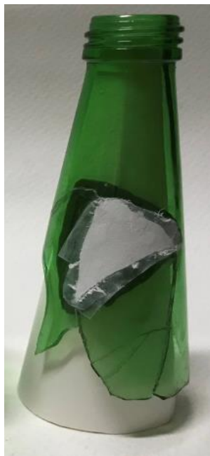
Figura 57 – Motlle un cop aplicada l’escaiola.
