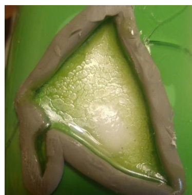
Figura 79 – Reintegració amb massa poca resina a causa de les parets baixes. Font: © C. Zabala (2019) 79_M1_falta_resina.jpg
