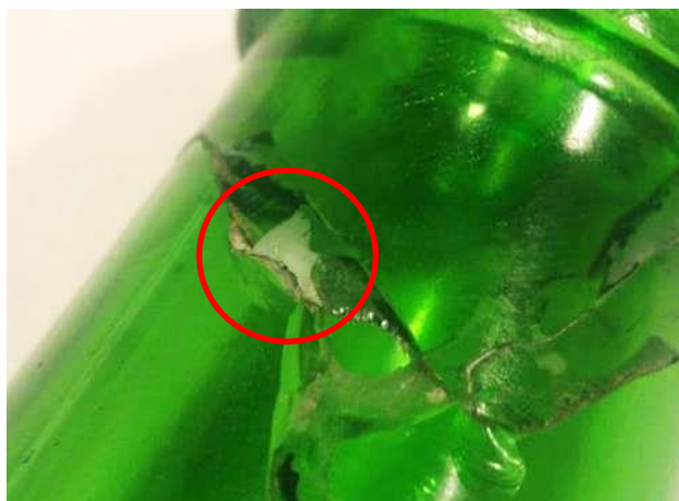
Figura 77 – Detall d'una resta de silicona que ha quedat dins una esquerda.
