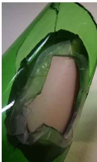
Figura 45 – Detall del motlle amb Parafilm® M i làmina de cera. Font: © C. Zabala (2019) 45_M3_DT_detall_motlle_cera.jpg
