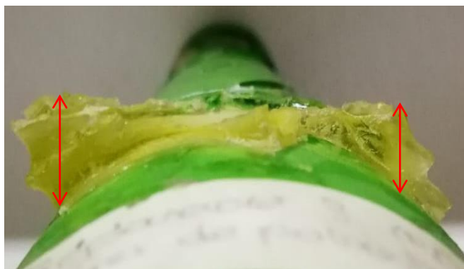
Figura 78 – Volum de resina que agafa la reintegració quan la pèrdua està en una zona molt corba. Font: © C. Zabala (2019) 78_M1_volum_resina.jpg
