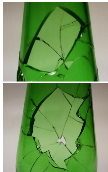
Figura 14 – Detall de les pèrdues del recipient 2 abans de la intervenció.
