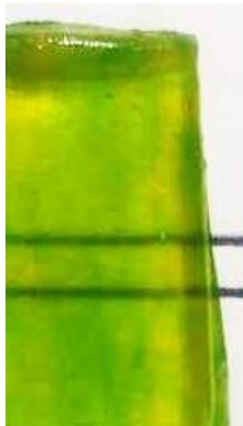
Figura 71 – Taques en les mostres de resina epoxídica acolorida amb pintura acrílica. Font: © C. Zabala (2019) 71_PR1_acolorit_taqes_epoxi.jpg
