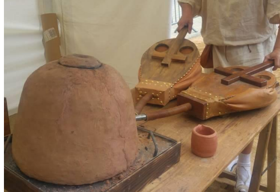
Figura 5 – Rèplica a petita escala d'un forn romà per fondre vidre. Font: © C. Zabala (2019) 5_forn_roma.jpg
