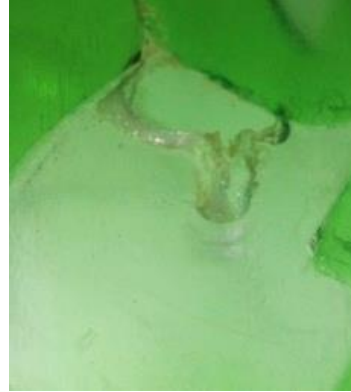
Figura 81 – Falta de resina en la reintegració a causa d'una bombolla en el mètode amb canyes. Font: © C. Zabala (2019) 81_M2_bombolla_canyes.jpg
