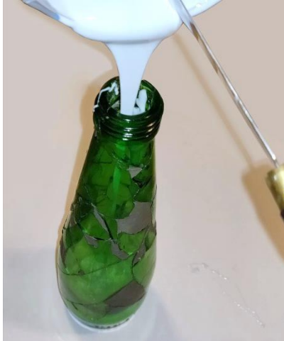
Figura 20 – Introduint la silicona dins el recipient per fer la membrana.
