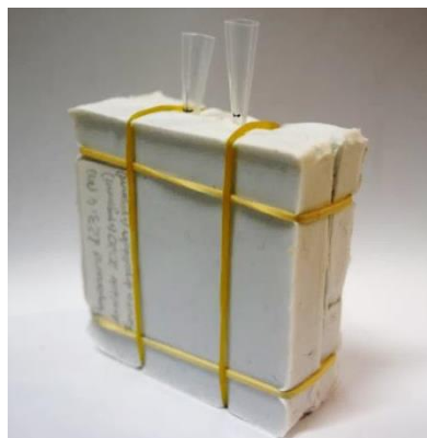
Figura 50 – Motlle de silicona exterior llest per introduir-hi la resina. Font: © C. Zabala (2019) 50_M3_DT_fmottle.jpg
