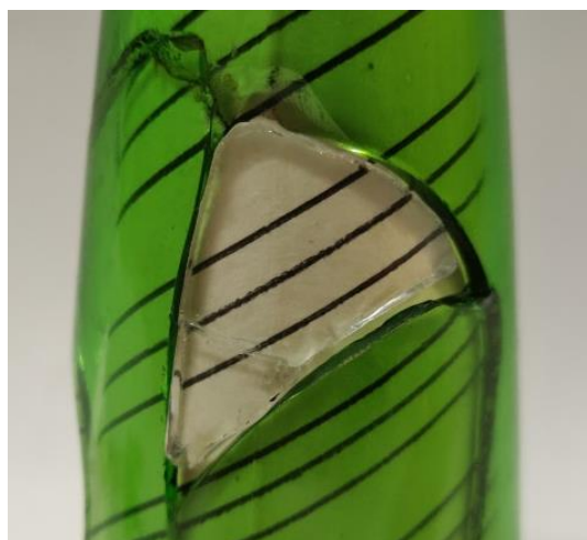
Figura 62 – Peça de vidre visió frontal, es pot observar la fractura per l'extrem inferior . Font: © C. Zabala (2019) 62_M4_DT_detall_vidre_fractura.jpg
