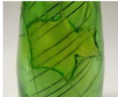
Figura 33 – Detall resina de polièster amb pintura acrílica. Font: © C. Zabala (2019) 33_M1_FT_detall_poliester_pintura.jpg
