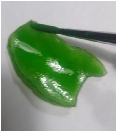
Figura 53 – Acolorit de la resina epoxídica amb pintura acrílica Font: © C. Zabala (2019) 53_M3_DT_aplicacio_pintura.jpg
