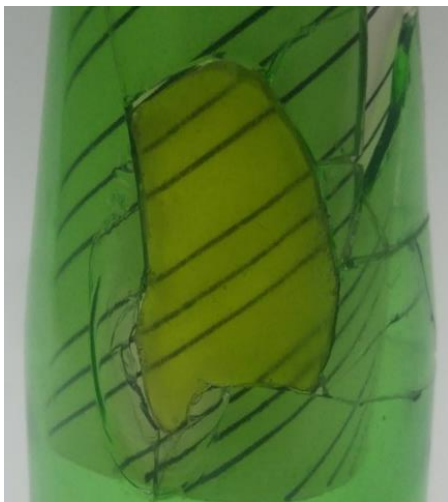
Figura 55 – Resultat final de la peça de resina col·locada dins la pèrdua. Font: © C. Zabala (2019) 55_M3_FT_detall_reintegracio.jpg
