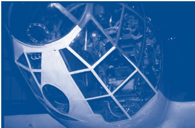
Foto 6. Al principi de l'aplicació del PMMA els enginyers es van llançar sovint a la recerca de la perfecta aerodinàmica combinada amb la perfecta visibilitat, malgrat que les xapes disponibles no admetien més que lleugeres corbes. Aquest morro de He-111 és un exemple del resultat: nombroses facetes separades que formen un conjunt pesat i amb visibilitat no gens satisfactòria a causa dels fenòmens de refracció i distorsió. (Foto de l'autor.)
