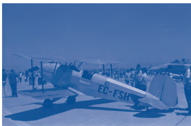
Foto 2. Aquest biplà Bü-131 és un disseny dels anys trenta, però il·lustra molt bé la construcció «clàssica»: es pot veure la tela ben tensada sobre els travessers de fusellatge i sobre les costelles dels plans i deriva, on produeix el típic efecte «ondulat». Els propietaris han decidit que la protecció contra l'UV prevalia sobre l'aspecte i han emprat laca aluminitzada per a l'acabat. (Foto de l'autor.)
