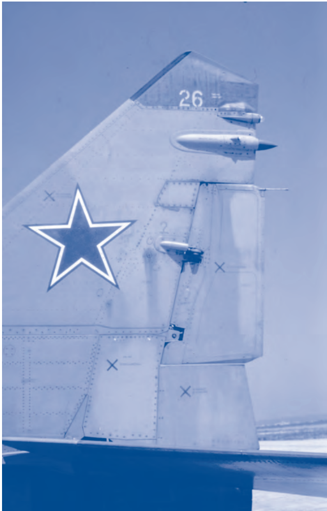
Foto 12. Les particulars característiques dels compòsits van fer que a l'antiga Unió Soviètica es considerés necessari indicar de forma visible la seva natura. A la deriva d'aquest MiG-29 els elements en compòsit van marcats amb una X i la descripció del material. (Foto de l'autor.)
