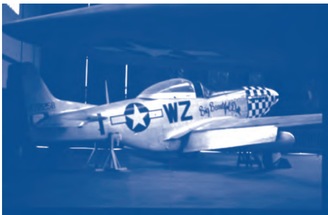
Foto 7. Un caça P-51D. Malgrat que han passat tan sols quatre anys de l'exemple anterior, el termoconformat del PMMA ha progressat fins a permetre produir «bombolles» (anglès, bubble canopies ) de qualitat òptica gairebé perfecta. (Foto de l'autor.)
