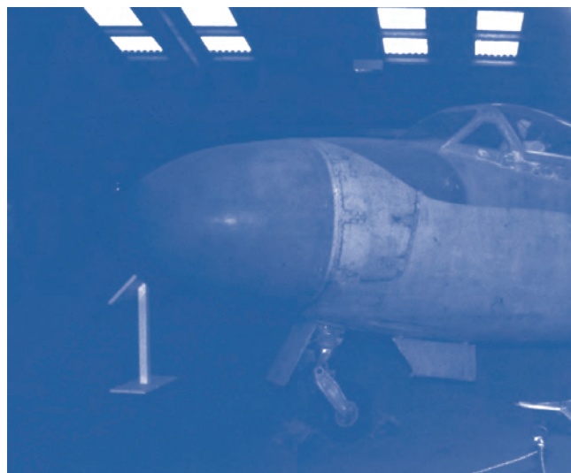
Foto 9. Representatiu de l'ús del GRP als anys quaranta-seixanta, el radom d'aquest Sea Venom mostra clarament el desgast a causa del fregament, que ha erosionat el gelcoat negre exterior fins a fer-lo quasi desaparèixer, i que ha deixat a la vista el GRP clar. (Foto de l'autor.)
