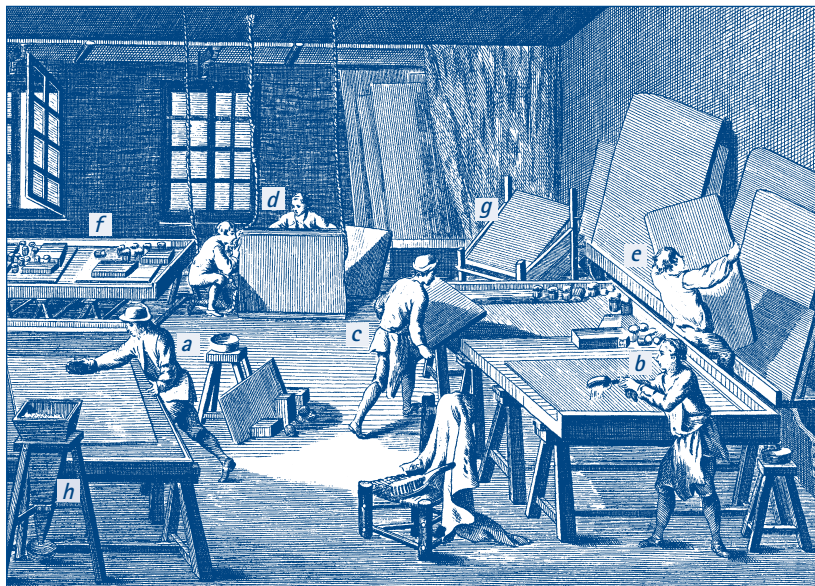
FIGURA 2. Taller de fabricació de miralls descrit a l' Encyclopédie de Diderot i D'Alembert, en el qual es veuen obrers en les tasques de desengreixar un full d'estany (a), abocar mercuri (vif-argent) sobre un full d'estany (b), col·locar un vidre sobre el full d'estany (c) o posar miralls sobre escorredors (d i g). Es veu també a la part inferior esquerra (h) una tremuja per a separar el mercuri d'altres residus.
