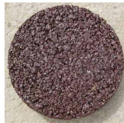
5.2.6. Detalle de mezcla de betún asfáltico pigmentado de color rojo
