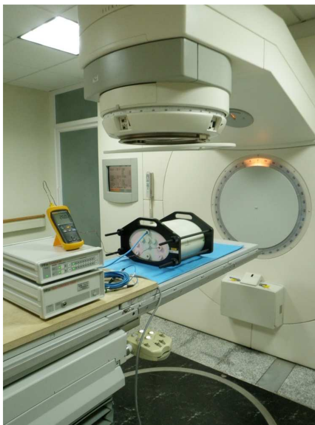
Figura 15. Muestra el sistema montado para realizar el caso complejo colimado con MLC, se puede apreciar la posición del LINAC (0°) con respecto al fantoma antropomórfico.
