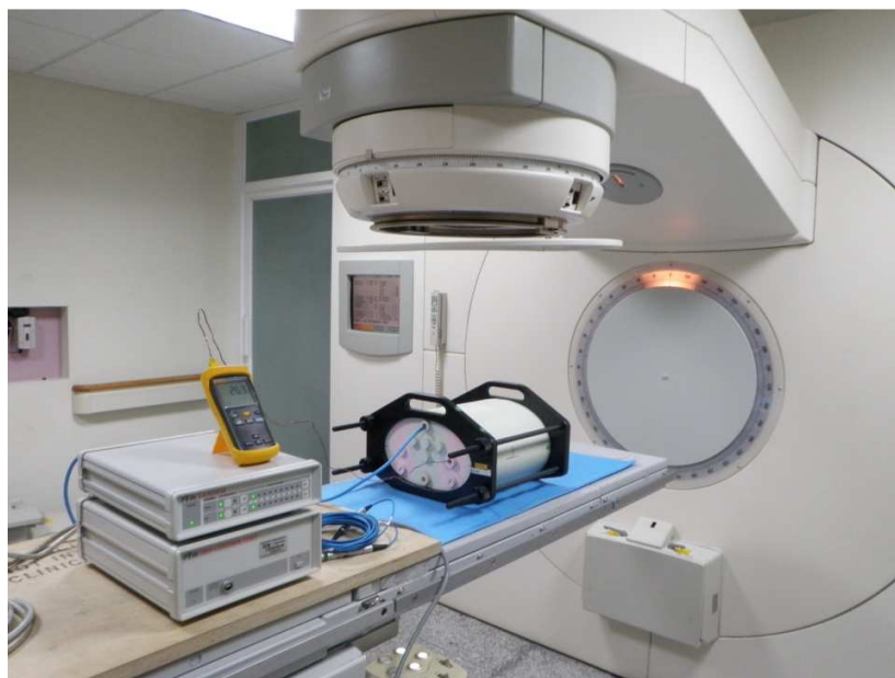
Figura 14. Muestra el sistema montado para realizar el caso simple, se puede apreciar la posición del LINAC ( 0^\circ ) con respecto al fantoma antropomórfico.
