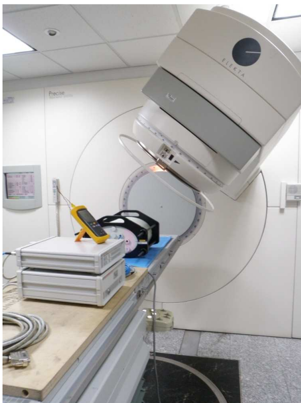
Figura 16. Muestra el sistema montado para realizar el caso oblicuo con cuña, se puede apreciar la posición del LINAC (45°) con respecto al fantoma antropomórfico.
