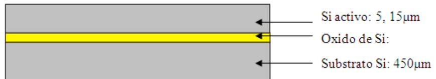
**Figura 1.4.** Esquema representativo de una oblea SOI
