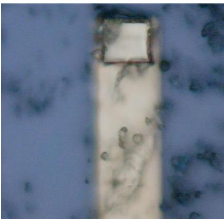
**Figura 1.18:** Zona de la oblea SOI , donde el cantilever conserva su pista conductora, en el caso de recubrimiento total de la pista conductora.
