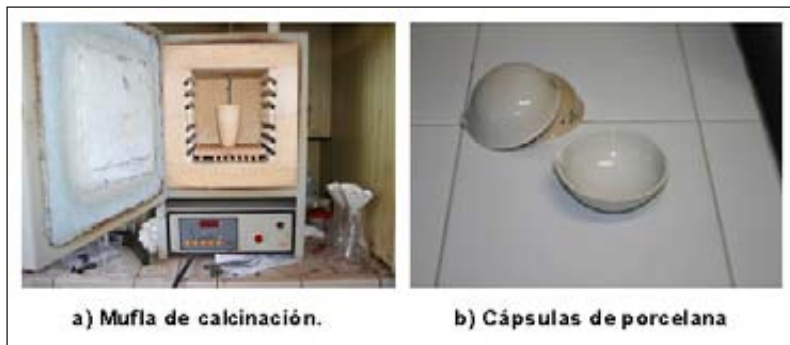
Fig. 9. Material de laboratorio necesario para la determinación de las pérdidas por calcinación
