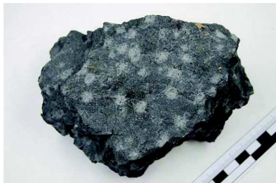
FIGURA 1. Típico moteado leucocrático presente en numerosas lavas basálticas alcalinas. En general, el moteado (en este caso de color gris claro) presenta formas bastante redondeadas.
