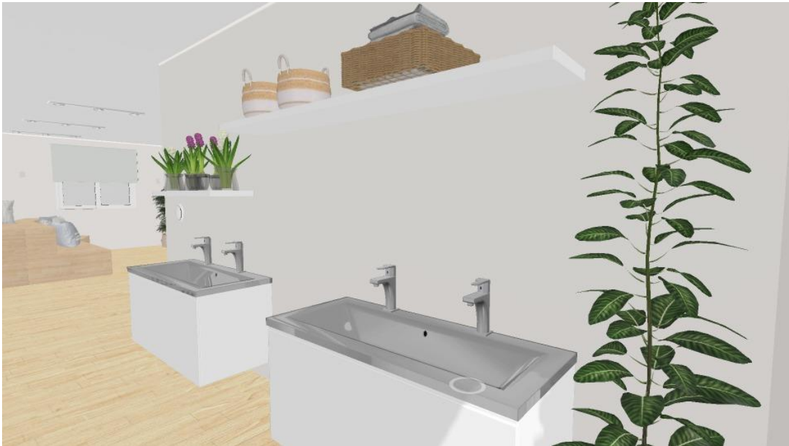
Imatge 36. Piques amb aigua i aixetes amb temporitzador que impedeixen l'obertura accidental i, per tant, l'excés de consum. Font. Elaboració pròpia.
