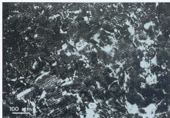
Figura 14: Micrografia en vista planar de la interfície GaAs/Si en la que s'ha usat la reflexió 220. S'observa un conjunt de dislocacions perpendiculars a aquesta direcció
