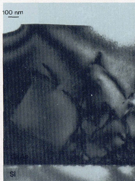
Figura 12: Micrografia en secció transversal on s'observen alguns defectes d'apilament i dislocacions filiformes
