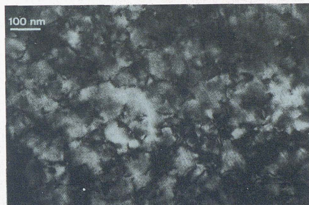
Figura 11: Micrografia en vista planar d'una interfície GaAs/Si on s'observa una malla creuada de franges de Moiré
