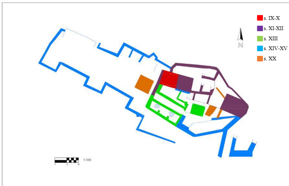
Planta 6. Estructures del castell de Palafolls en l'actualitat. Les estructures en vermell es corresponen a la fase del s. X, les de morat al s. XI-XII, en verd al s. XIII, en blau al s. XIV i en marró, les modificacions del s. XX.
