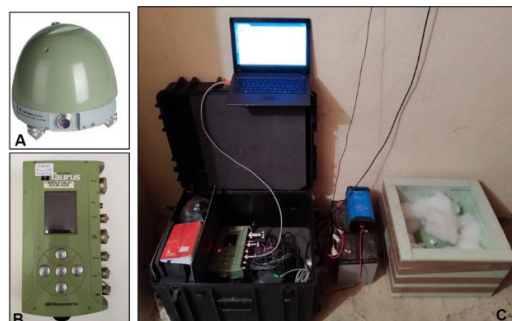
Figura 3. Instruments emprats per el projecte. A) Sensor Trillium 120P de Nanometrics, B) Estació Taurus de Nanometrics i C) exemple d'instal·lació típica realitzada en locals municipals o de particulars tancats com magatzems, ermites o cementiris.
