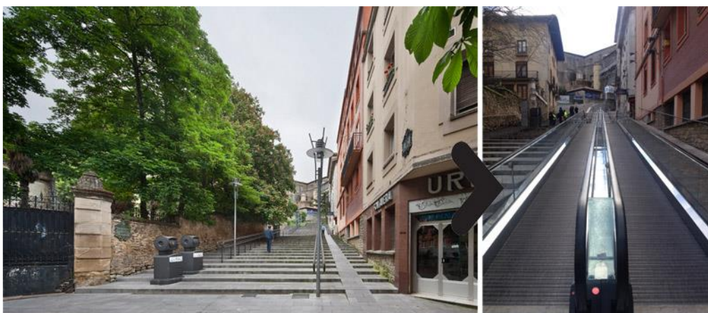
Ilustración 4. Incorporación de rampas disminuyendo el ancho de escaleras originales en Vitoria-Gasteiz
