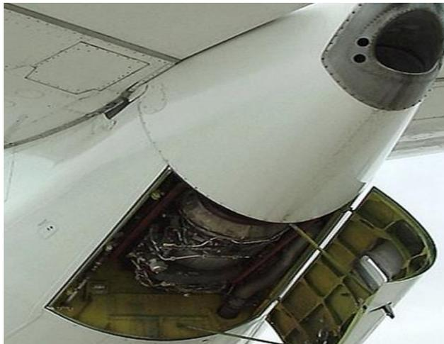
Esta Unidad Auxiliar de Poder consiste en un pequeño motor a reacción, cuya función es suministrar energía eléctrica a los sistemas del avión, además de energía neumática para su acondicionamiento o para el arranque de sus motores, por lo que no proporciona propulsión alguna a la aeronave.
