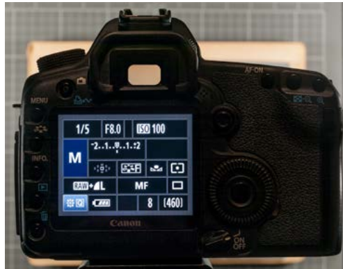
15. Configuración recomendada en una cámara Canon EOS 5D Mark II. El tiempo de obturación dependerá de la luz empleada. © Canon
