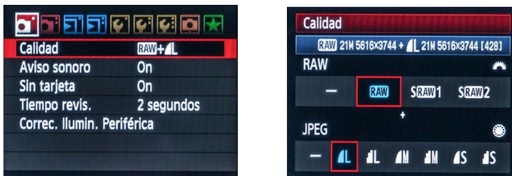
12. Ajuste de calidad de imagen en una cámara Canon EOS 5D Mark II. © Ricardo Guixà
