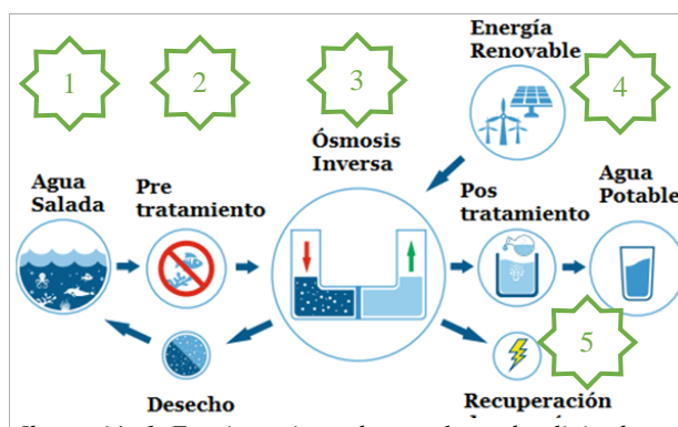
Ilustración 1. Funcionamiento de una planta desalinizadora.
