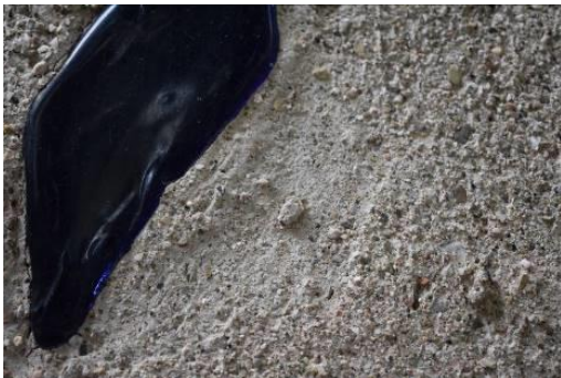
Granulometria gruixuda del formigó del vitrall d'estudi.
