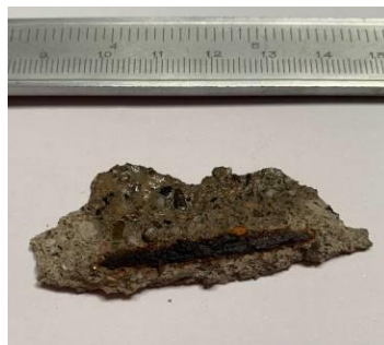
Prova de la fenolftaleïna feta a un tros després de formigó (imatge central) i prova feta a una zona lateral del vitrall d’estudi (dreta), amb resultat és negatiu (el líquid no s’ha tornat fucsia).
