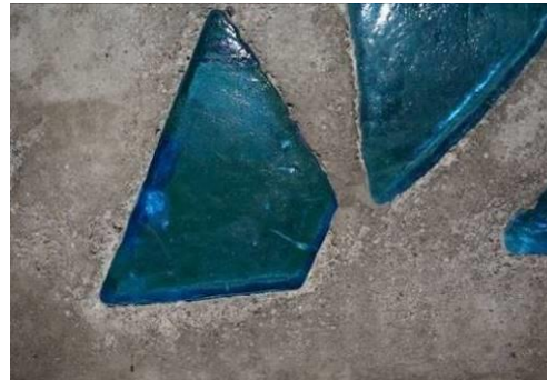
Granulometria fina del formigó del vitrall d'estudi.
